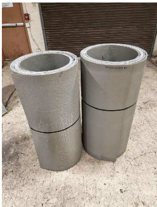
Fig. 1: Laminados FRP hechos de hojas de fibra de carbono o fibra de vidrio de hasta 9 pies de ancho, saturada con resina y probado a través de una prensa
