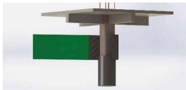
Fig. 3: Instalación de laminados alrededor de la columna para crear una carcasa
